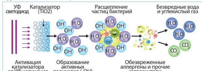
При воздействии излучения УФ-светодиодного модуля на катализатор образуются натуральные вещества с высокой окислительной способностью, такие как гидроксидные радикалы ( $\text{OH}^-$ ), которые разлагают попавшие на поверхность катализатора загрязняющие вещества на безвредные вещества (в основном воду и углекислый газ). Благодаря молекулам перекиси водорода, хорошо известным своим антисептическим действием, достигается молекулярный уровень защиты от патогенных микроорганизмов.
